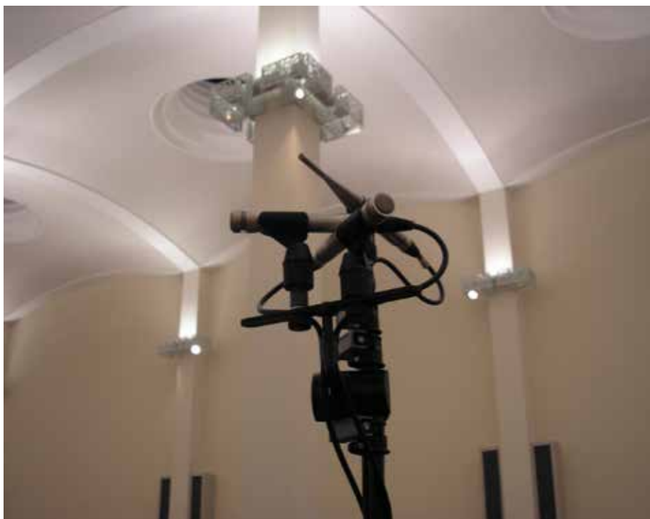
Das mittlere Stativ trägt die zwei Elation m201 Mikrofone in ORTF-Anordnung. Darüber ist das Earthworks QTC-1 angebracht, das den Center-Kanal für die Surround-Abnahme aufnimmt.
