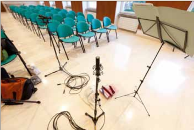
Ein Royer Labs SF-1 Bänchenmikrofon dient beim Mitschnitt des Trio Ecoensemble als gemeinsamer Spot für Flöte und Oboe.
