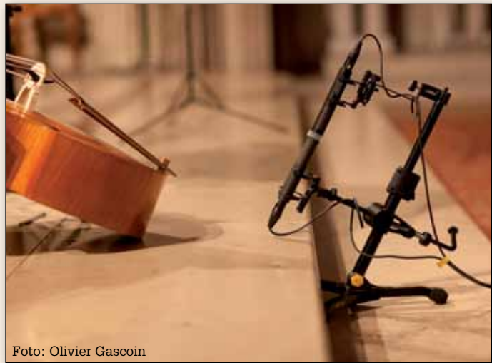
Ein M/S-Paar zu Füßen der Cellistin dient der Abnahme der Viola da Gamba.
