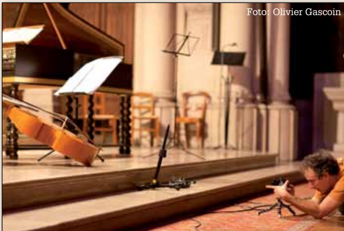
Ein M/S-Paar zu Füßen der Cellistin dient der Abnahme der Viola da Gamba.
