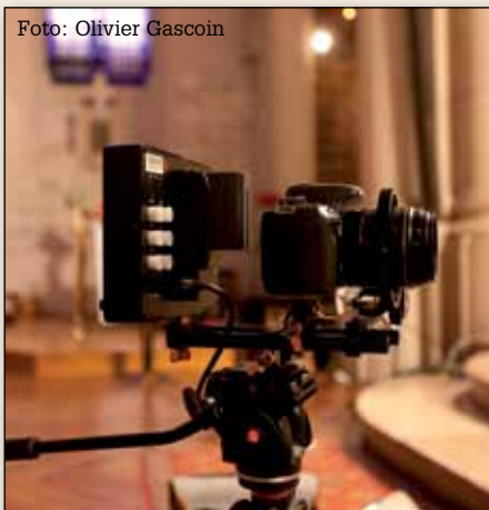
Eine der Canon EOS 550D-Kameras mit zusätzlichem HDMI-Monitor und Follow-Focus-System für punktgenaues Setzen der Schärfe.
