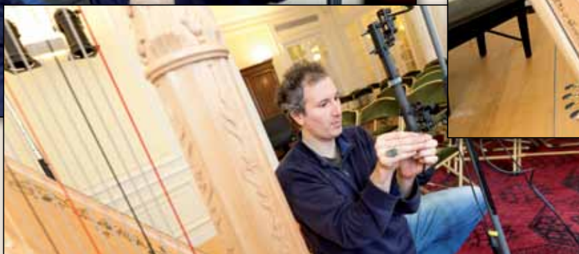
Für das erste Konzert, ein Solorecital des niederländischen Harfenisten Remy van Kesteren genügt ein Blumlein-Arrangement mit 2 Royer Labs SF-1 Bändchen-Mikrofonen nahe am Korpus der Harfe. Dieses Konzert wird noch nicht gefilmt. (Fotos: Oliver Gascoïn)
