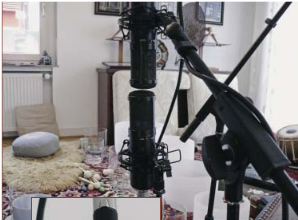
Das Stereo-Hauptmikrofon aus der Nähe. Im Hintergrund: Die beiden Kissen gehören zu den einfachen, aber effektiven Maßnahmen, erste Reflektionen in den Griff zu bekommen.
