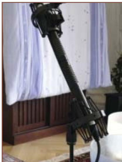
Die beiden Bändchen-Mikrofone RoyerLabs SF-1 in der finalen Blumlein-Anordnung: Sie nehmen den vergleichsweise komplexen Klang der Hang auf.
