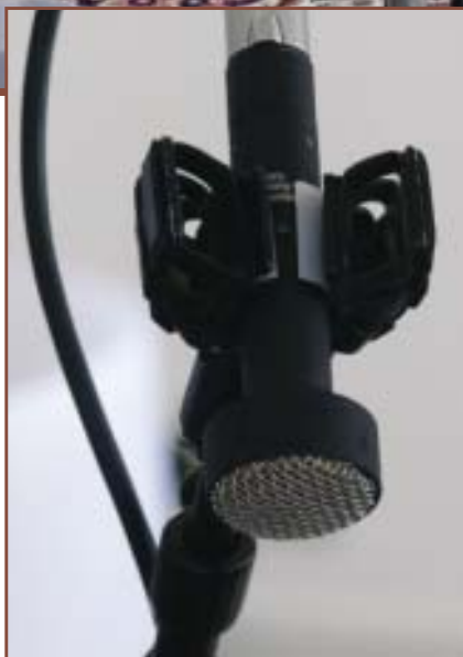
Das Stützmikrofon für die Flöten von Leann Eriksson: Ein von United Minorities getunt Oktava MK-102 mit Nierencharakteristik.
