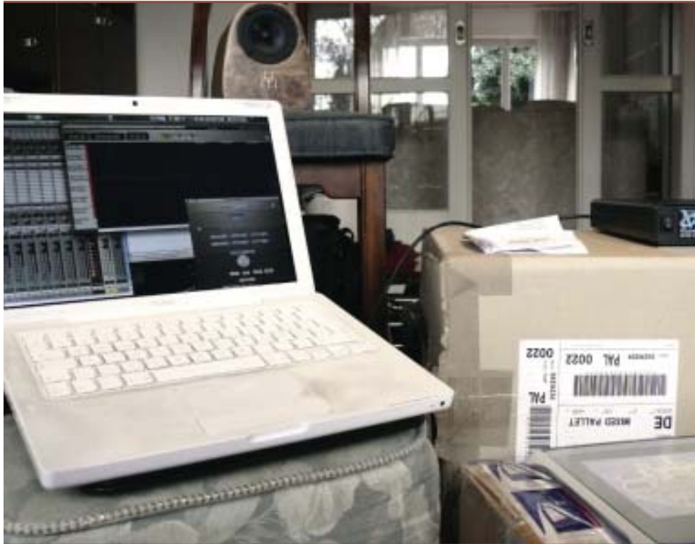
Andrew Levines mobile Regie: Im Vordergrund sein MacBook mit dem 2d-Mixer von Metric Halo. Dahinter einer der beiden Abhör-Monitore: Es handelt sich um den Breitbandlautsprecher Ginko von United Minorities.
